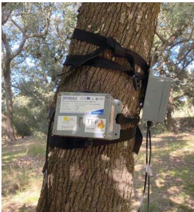
Безжичен сензор от проекта „Офидия 2“ е поставен върху дърво в природен парк в Пулия.
